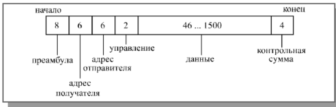
Рис 2. Структура пакета сети Ethernet
