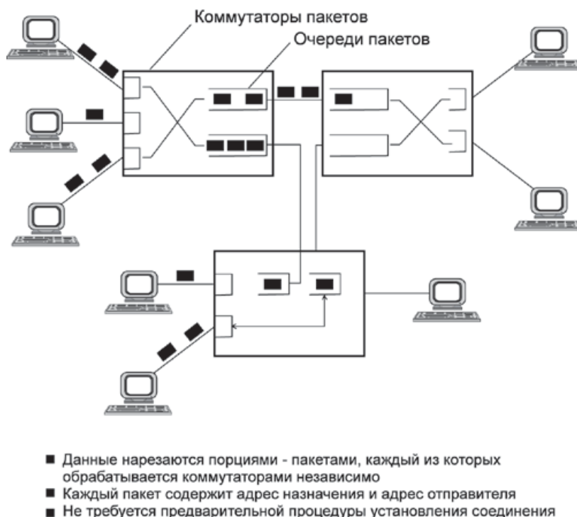
Рис. 6.4. Сглаживание пульсаций трафика в сети с коммутацией пакетов
