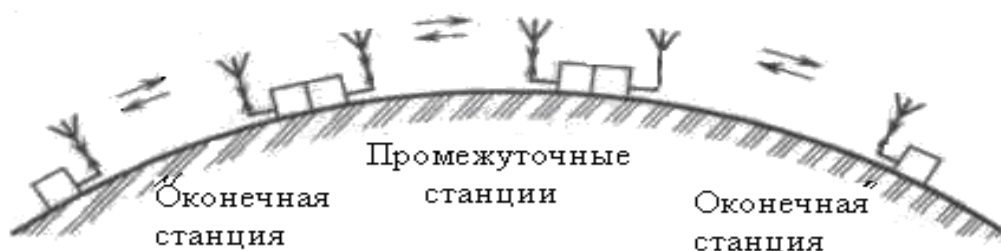
б. Схема радиорелейной линии связи
